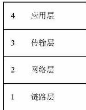
图 12.1 网络协议的层次结构
