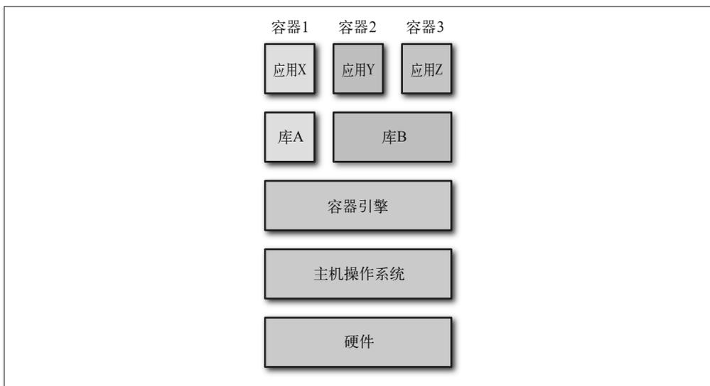
图 1-2: 运行在同一台主机上的 3 个容器
